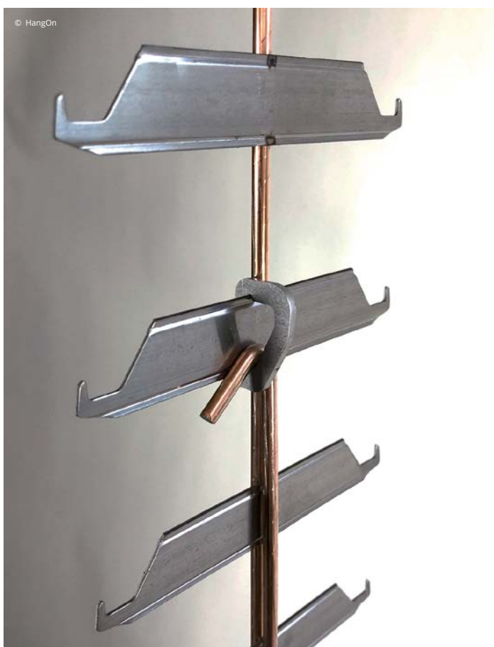
Figura 5 - Il telaio HQS è caratterizzato da lamelle metalliche per poter appendere dai singoli pezzi fino ai profili.
