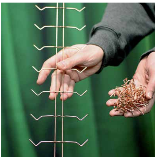
Obr. 1 – Rychlý drátový stromeček HQW D vs. „řetízkování“ pomocí malých háčků
