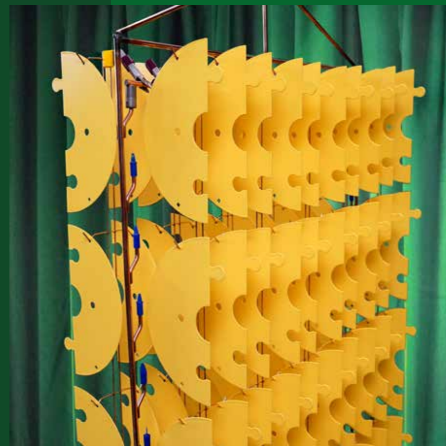
S oboustrannými BHL patry můžete dosáhnout neuvěřitelně vysoké hustoty zavěšení.
