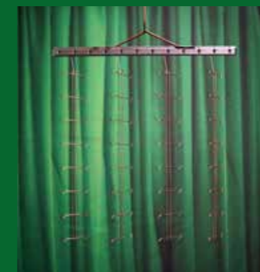
Použití háčků s úhlem otočení 45° umožňuje hustší zavěšení.
